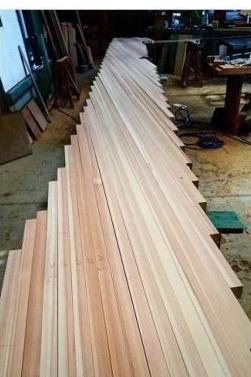
木材は一般的に400mmまでが定尺であり、これを超えると材価が上昇します。一般流通材であり座敷で用いられる廻縁(45×45×4000mm)を使用し、これを斜めに接ぎ合せることで、低価格化を実現しました。廻縁の4000mmをトリミング幅を考慮して最大になるように傾角を設定し、ロスを少なくする工夫をしています。
