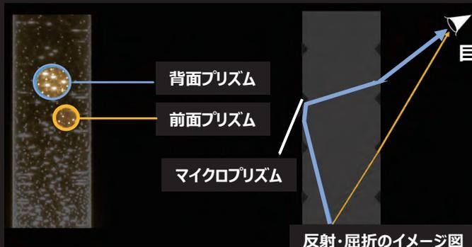
LEDの光をうけ「導光ロッド」表面に配置したマイクロプリズムがきらめく
