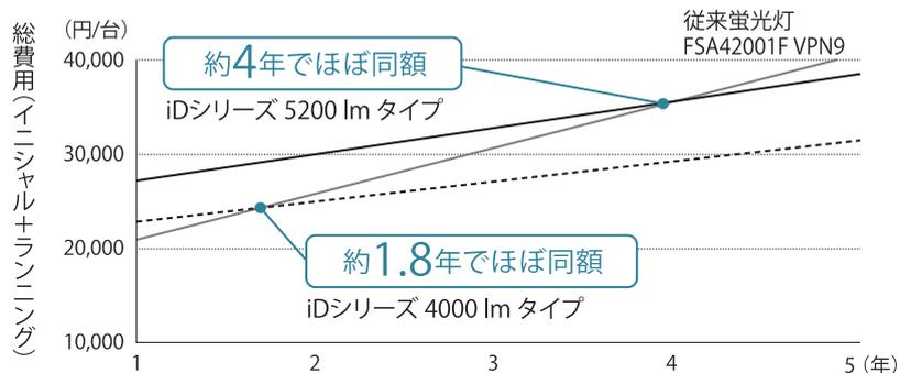
※ 当社従来蛍光灯器具FSA42001F VPN9(2012年度機種)とiDシリーズ5200lmタイプ(器具本体NNFK90515、ライトバー NNU601005 LE9)と4000lmタイプ(器具本体NNFK90515、ライトバー NNU500005 LE9)との比較。電気代単価:21円/kWh(税込)、年間点灯時間3000時間、従来蛍光灯器具の交換費用(器具代・ランプ代)を含む。
