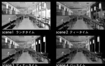
簡単なボタン操作によって複数の照明器具を使ったあかりのシーンを4画面まで記憶。シーン選択ボタンを押すだけで記憶したシーンが再生されます。また、マスター調光機能で全体の明るさを一齊に変えることもできます。
