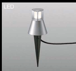
DWP-36058 ¥34,440 5W LEDウォームホワイト ●アルミダイカスト・アルミ管 メタリックシルバー塗装 ●アクリル 乳白 ●径Φ120 高180 埋込深190mm ■キャプタイヤコード5m付 ■差込プラグ付 <意匠登録出願中>
